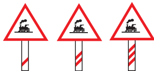
Cruce ferroviario a 100, 200 y 300 metros
